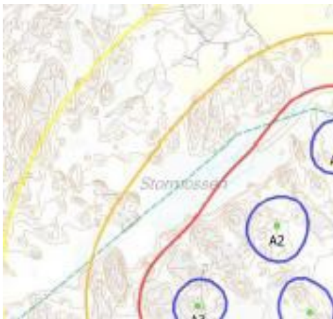
KUVA 2 melumallinnoksesta syyskuu 2013. Huomioitavaa, että melukäyrät eivät myötäile maaston muotoja. Tämä on mahdollista vain, kun topografiaa ei ole huomioitu.
